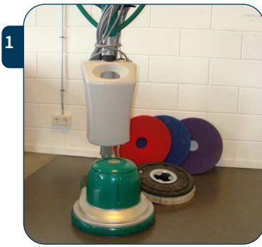
1 Materiaal: Eenschijfsmachine (duo speed)/ Padhouder/ Rode pad.
